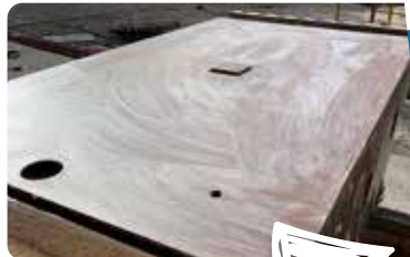
Kompensacja szczeliny płyty dociskowej w kamieniołomie WEICON HB 300
